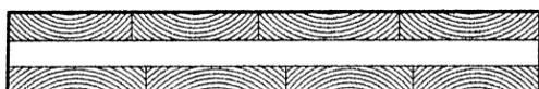
Figura A1.1: Estructura principal de un panel de tablas de madera maciza de 3 capas.
